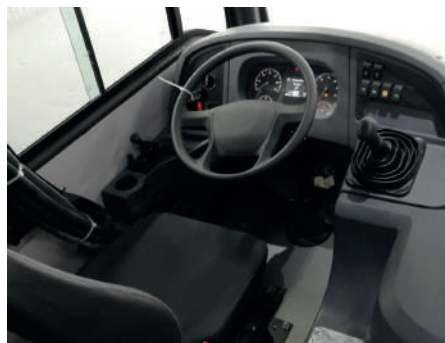
Cinturón de seguridad de tres puntos para el conductor con mecanismo retráctil.
