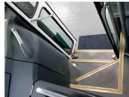
Escaleras en acero galvanizado con huellas de aluminio antiderrapante.
