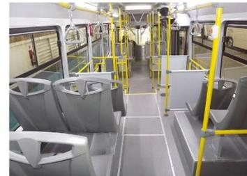
Revestimiento del piso en linóleo antiderrapante en el centro del pasillo y liso en los laterales bajo los asientos
