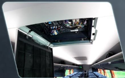
Sistema electrónico con control integrado con la Head Unit.
