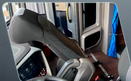
Asiento del conductor auxiliar retráctil que facilita el acceso a la cabina.
