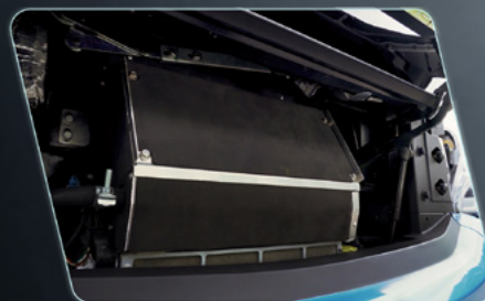
Defroster y aire acondicionado repositionados para facilitar el mantenimiento de los equipos de refrigeración y calefacción.
